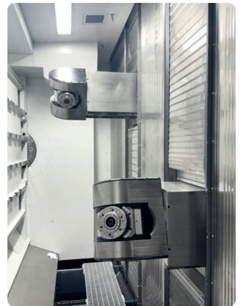
Les machines SW à 2 broches offrent une productivité par unité de surface 2 fois supérieure. La vitesse d'avance rapide de la BA space3-22 est de 120 m/min contre 70-80 m/min pour la concurrence.
