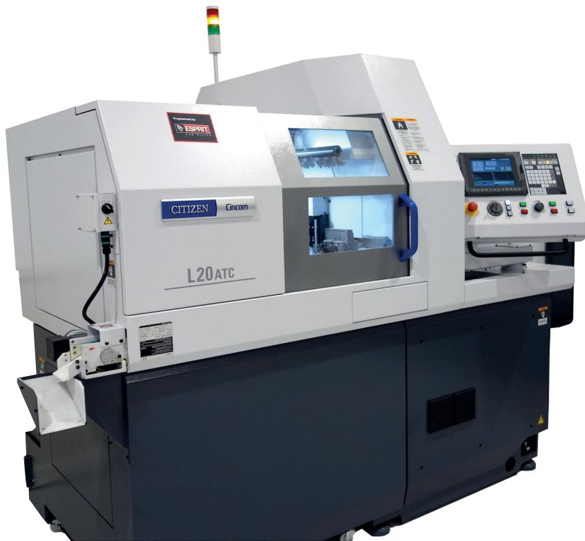
être équipé, pour l'usinage de contour, d'un maximum de cinq axes pilotés, y compris axe B (type VIII). Le porte-outils pour l'usinage arrière dispose d'outils entrainés à réglage angulaire (types VII et VIII), ce qui lui permet de maîtriser les tâches d'usinage complexes en association avec l'axe Y.
