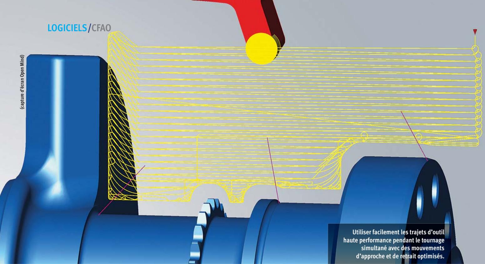
Utiliser facilement les trajets d'outil haute performance pendant le tournage simultané avec des mouvements d'approche et de retrait optimisés.
