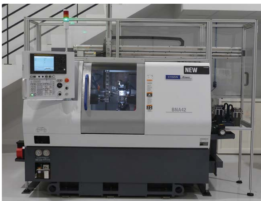
Citizen intègre désormais des robots sur ses machines Miyano. Ici, un tour BNA42, dans le show-room d'Hestika France, à Ayze (Haute-Savoie).
