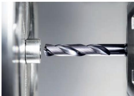
► Mortaisage du six pans avec le système Supermini type N105.
