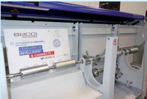
Les embarreurs lemca communiquent désormais les données vibratoires à la CNC de la machine-outil.
