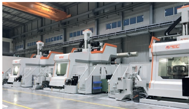
› Ligne de production de carters moteurs chez AIDC, équipée de Centres d'Usinage 5 axes Apec MDU-2000
