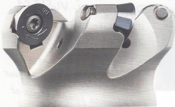
Boehlerit\_Zetatec : Fraise à emboîter d'ébauche ZETAtec 90N. Utilisable aussi pour la plongée hélicoïdale et linéaire malgré la géométrie de base négative.
