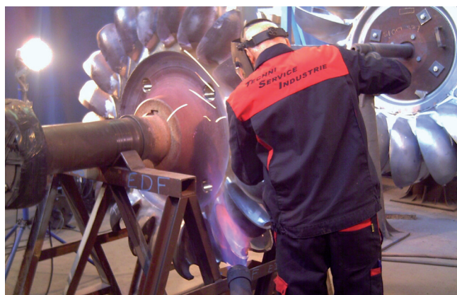
Opération de parachèvement d'une roue de turbine de barrage (roue Pelto).
